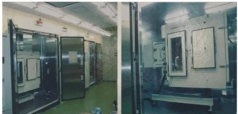
<空気エンタルピ法試験室>
